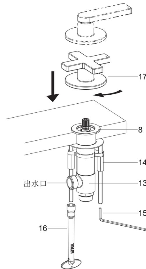
根据软管安装需要适当调整阀体出水口朝向。用3mm的六角扳手(15)锁紧螺杆以固定阀体。用扳手(16)锁紧螺母(14)。
