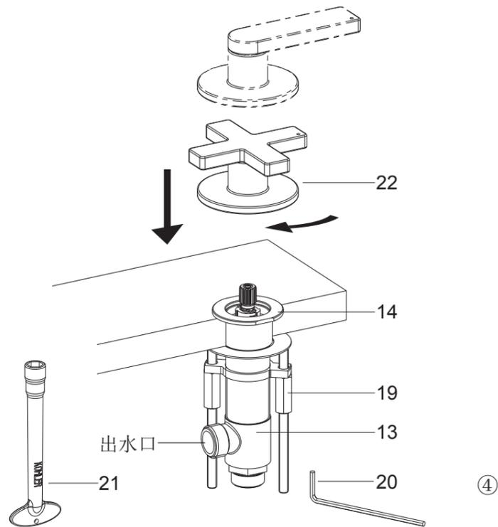
根据软管安装需要适当调整阀体出水口朝向。用3mm的六角扳手(20)锁紧螺杆以固定阀体。用工具(21)锁紧螺母(19)。
