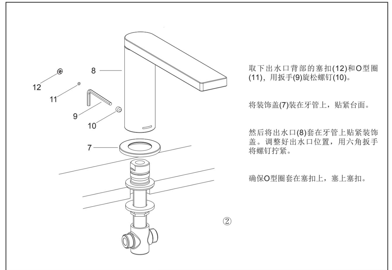
取下出水口背部的塞扣(12)和O型圈(11),用扳手(9)旋松螺钉(10)。
