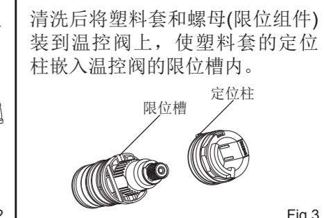
**注意:** 确保拆卸、安装过程中不要转动温控阀轴。如不小心转动了阀轴, 要调整阀轴使外齿上的圆孔标识与相邻的塑料套上的凹槽对齐, 或者按前述方法进行调整。
