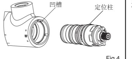
安装轴套及温控把手(不要转动温控阀轴), 使参考标识同数字37对齐, 拧紧螺钉。安装把手上盖。
