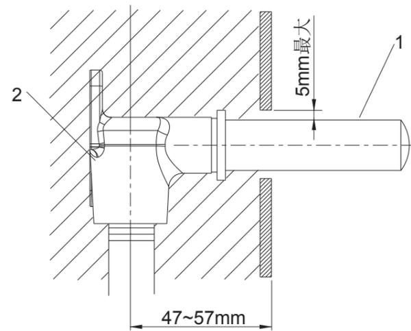
冷热供水管与已装修好的墙面之间距离应为47~57mm。确保保护套和最终墙面之间的缝隙不大于5mm。
