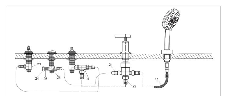
把垫片(26)放入螺母(24),并将其旋到所选配浴缸龙 头出水口的T型接头(25)的任意端口上锁紧。
