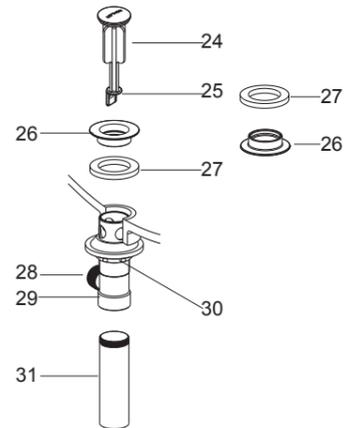
**注意：**如果需要，可直接在法兰盘(26)底面沿周围涂一圈密封油灰，或其他密封剂，而不使用垫片(27)。
