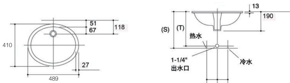
(T)使用提拉杆去水头333mm，使用链条塞子去水头311mm。
