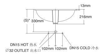
(S)单孔(254mm), 4寸孔(254mm), 8寸孔(356mm); 此尺寸根据305mm冒口计算, 须接实际情况调整。
