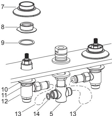
将垫片(14)放入软管(13)的两端。如图所示，将阀体(12)与T型接头(5)用软管连接。**注意：**软管(13)只能用在此处。
