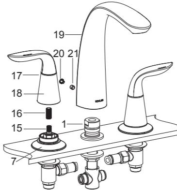
将出水口(19)插入牙管(1)，直至与台面接触。用六角扳手锁紧出水口背部螺钉(21)，将塞子(20)塞入螺钉孔。
