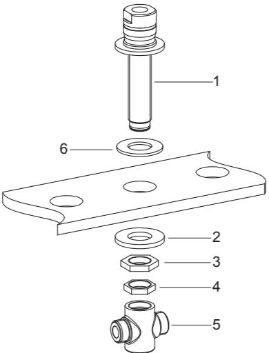
安装垫片(2)和螺母(3、4)。上下同时用力拧紧螺母(3)，然后拧紧螺母(4)。
