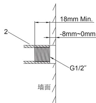
为使安装顺利， $G1/2"$ 内螺纹管道配件(2)应已装好，管道配件要垂直且不能突出装修好的墙面，但低于墙面不能超过8mm，螺纹长度最少18mm。
