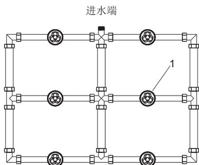
为了获得更好的客户体验，推荐身体喷头(1)的管路排布应如上图所示。请根据实际使用需求，确定安装高度及身体喷头之间距离。
