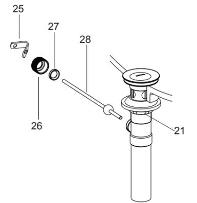
把手捻螺丝(29)装到联杆(30)上。用“V”形夹(25)将联杆连到球杆(28)上，将提拉杆(8)插入联杆的孔中，将球杆下推至排水组件全开位置，调整提拉杆的位置。拧紧手捻螺丝。
